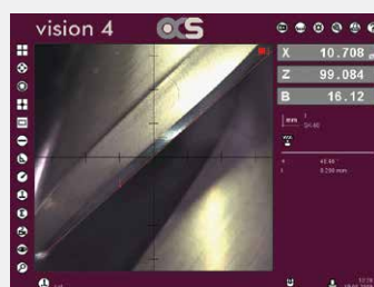
Fasensbreite mit Lotfunktion Chamfer width with perpendicular
