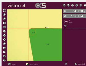
Schneidenerkennung und Vermessung mit virtuellem Fadenkreuz Automatic cutting edge detection with virtual crosshair
