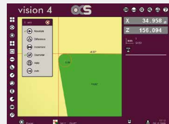
R/D und Absolut-/Kettenmass Auswahlmenue radius/dia and abs/inc selectable
