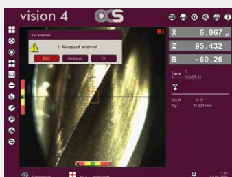
Spiralsteigung und -winkel Spiral pitch and angle
