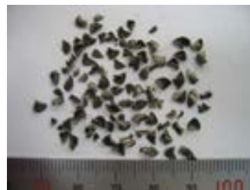
切りくずの状態 Chip shape
